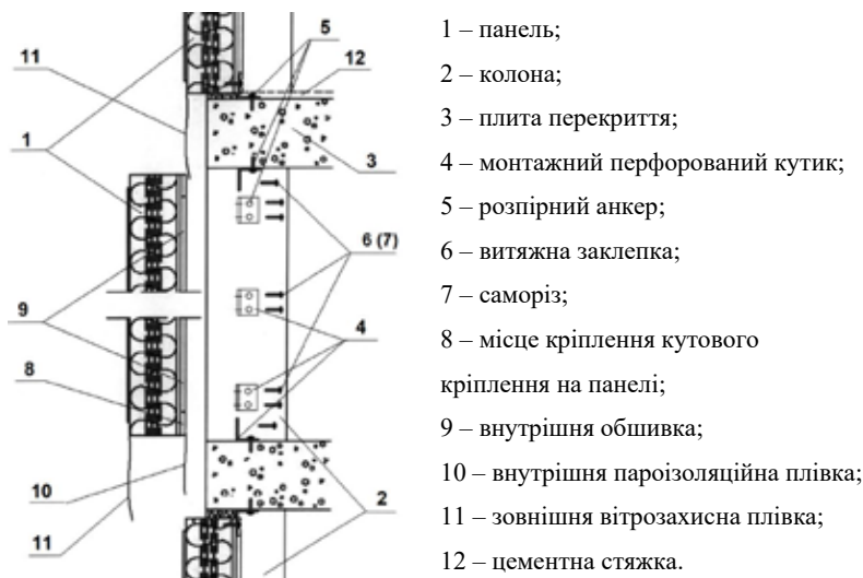
Рис. 4. Схема встановлення панелі [12]
