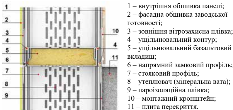
Рис. 5. Замкове з'єднання навісних стінових панелей
